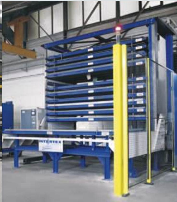
Kapazität: 12 Paletten / L 3.100 mm, T 1.500 mm, H 90 mm
