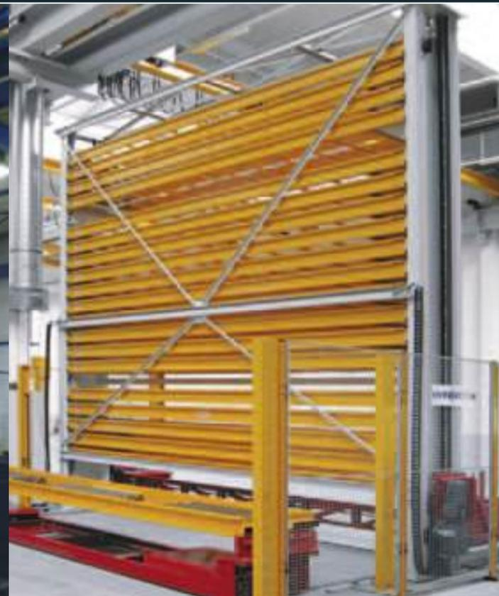
Kapazität: 20 Kassetten / L 6.300 mm, T 830 mm, H 150 mm
