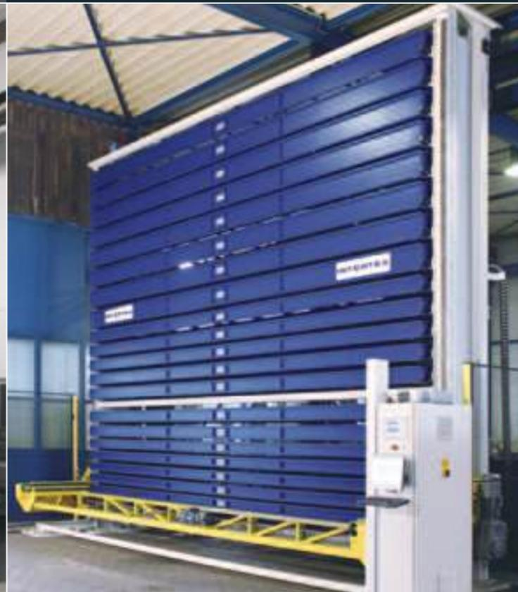
Kapazität: 20 Kassetten / L 6.300 mm, T 800 mm, H 100 / 150 / 250 mm
