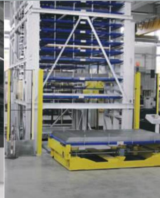
Kapazität: 56 Paletten / L 2.600 mm, T 1.400 mm, H 120 / 180 mm
