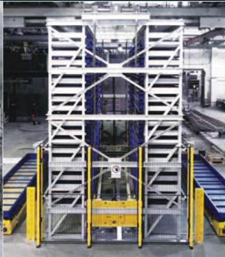
Kapazität: 38 Kassetten / L 6.300 mm, T 830 mm, H 150 / 200 mm
