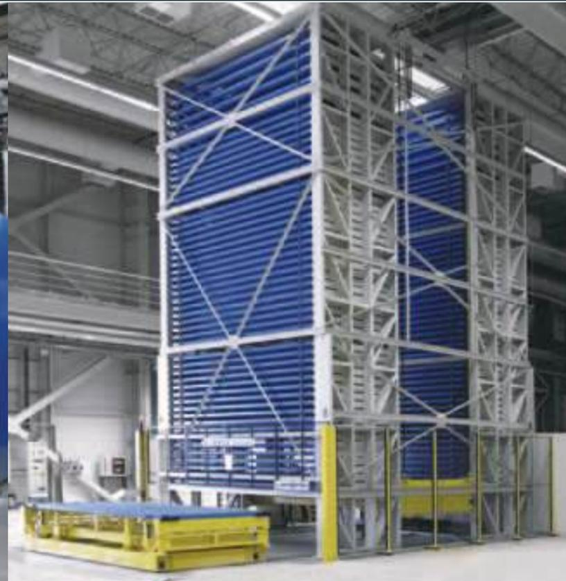
Kapazität: 102 Paletten / L 4.100 mm, T 2.100 mm, H 50 / 130 mm
