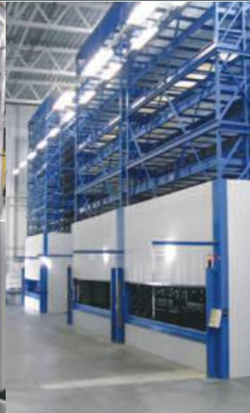
Kapazität: 24 Kassetten / L 6.300 mm, T 830 mm,
