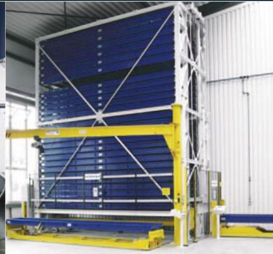
Kapazität: 54 Kassetten / L 6.500 mm, T 830 mm, H 185 / 245 mm
