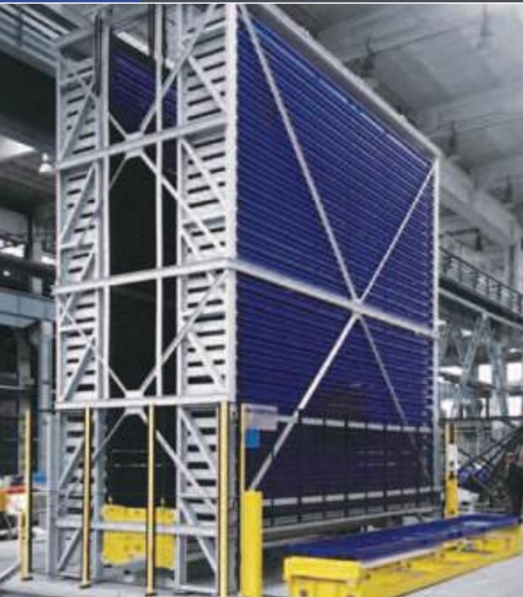
Kapazität: 67 Kassetten / L 6.300 mm, T 830 mm, H 110 / 150 mm
