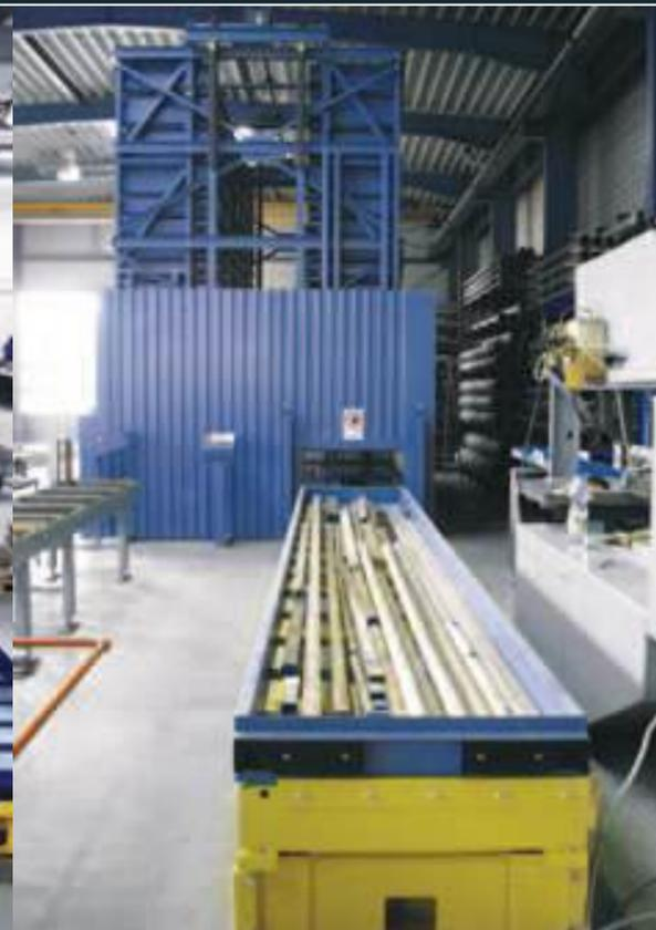
Kapazität: 32 Kassetten / L 6.500 mm, T 800 mm, H 150 / 300 mm
