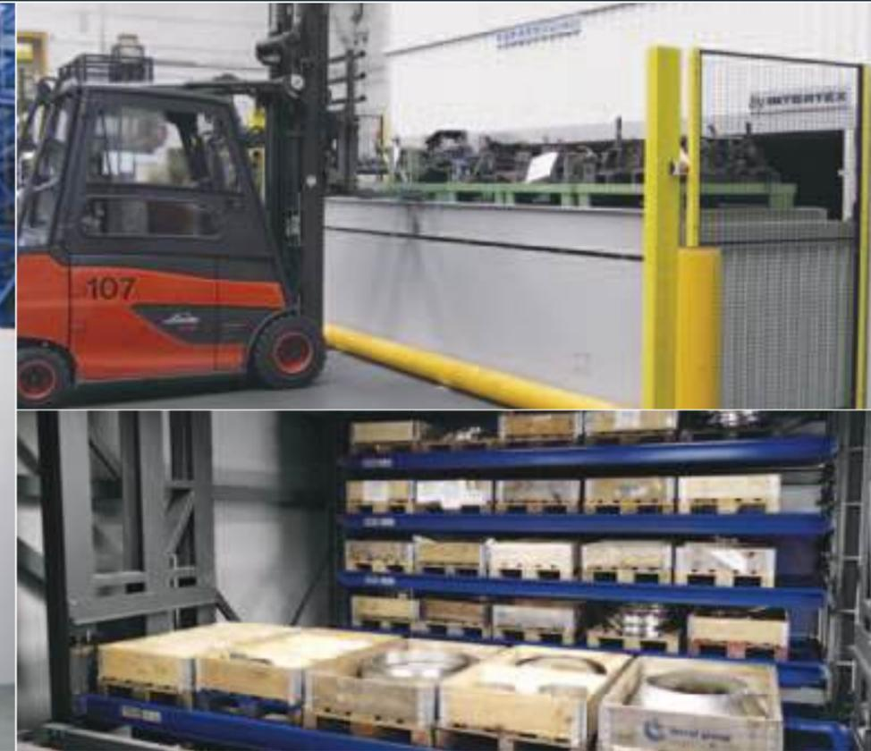
Kapazität: 28 Kassetten / L 6.000 mm, T 1.300 mm,
