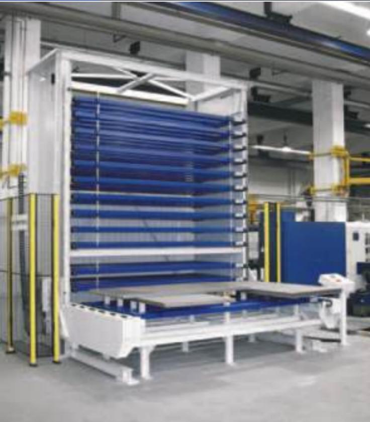
Kapazität: 13 Paletten / L 3.100 mm, T 1.540 mm, H 135 mm
