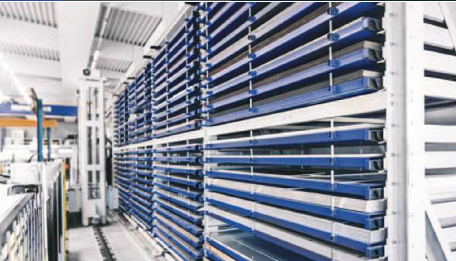
Kapazität: 84 Paletten / L 3.100 mm, T 1.540 mm, H 90 mm
