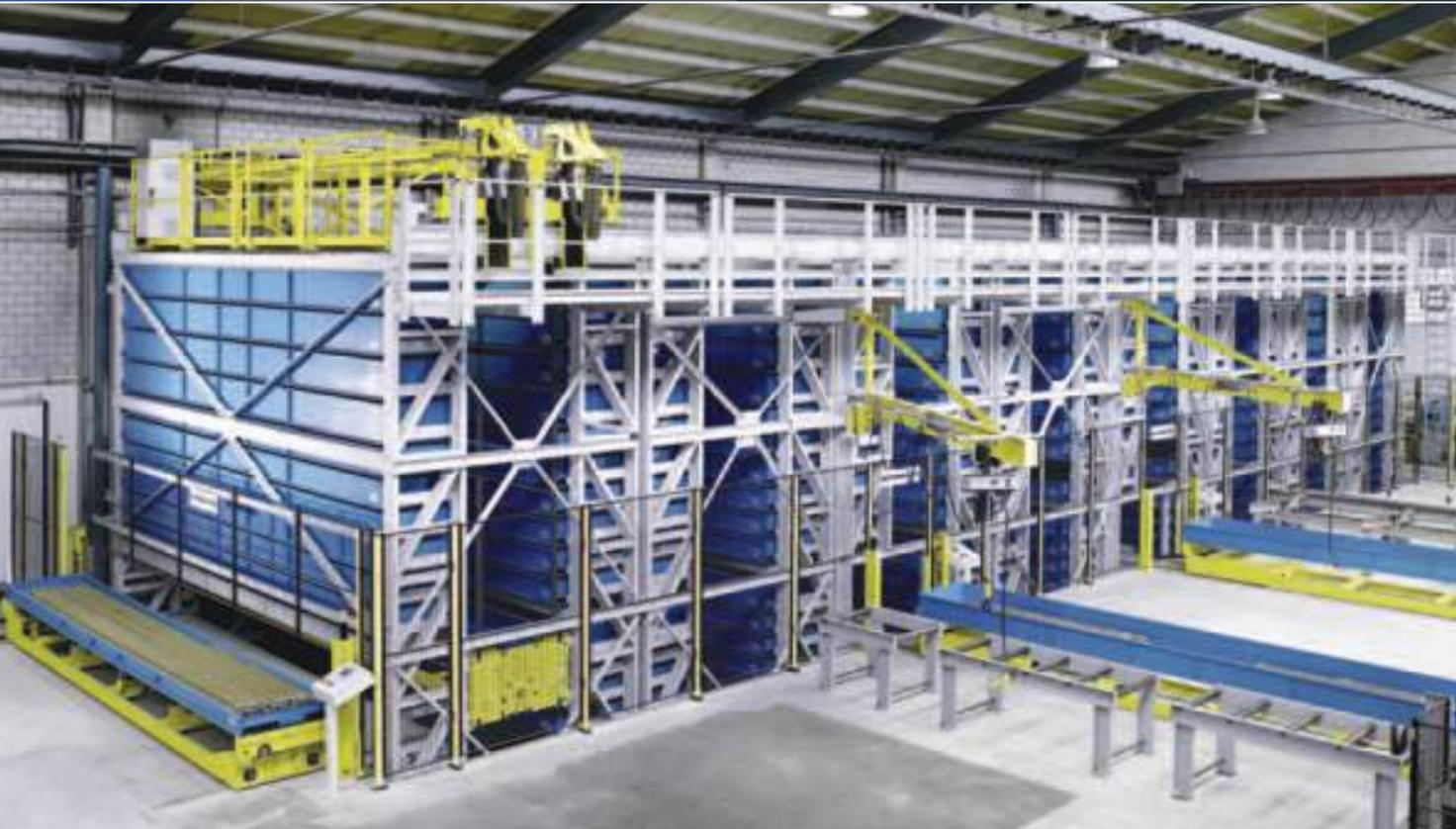
Kapazität: 356 Kassetten / L 6.800 mm, T 832 mm, H 150 / 200 / 250 / 350 mm
