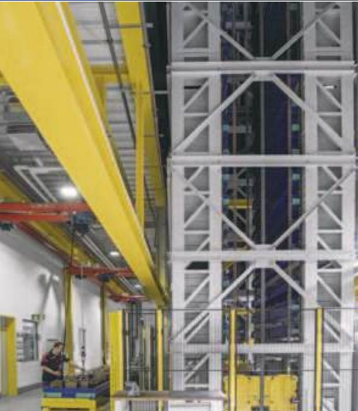
Kapazität: 61 Kassetten / L 3.500 mm, T 800 mm, H 240 / 480 / 640 mm
