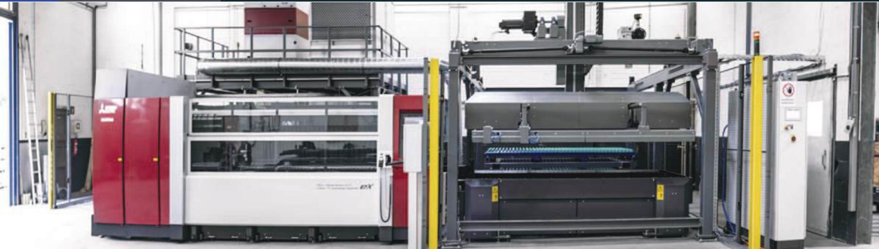
PickMat-3015 mit Rechensystem, Vakuumeinheit und für Großformatbleche bis 900 kg
