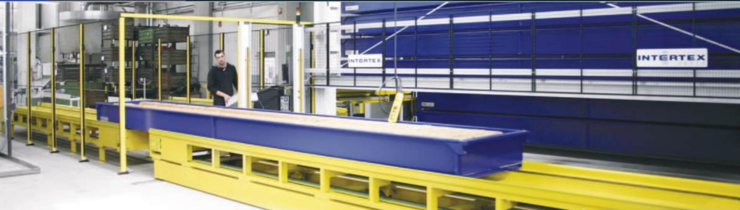
Die Kassetten werden über einen Beladewagen mit Kettenförderer auf einen Ablagetisch mit Kettenförderer ausgeschleust.
