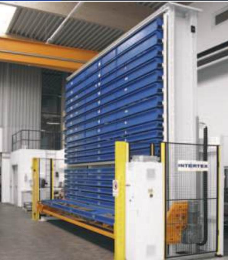
Kapazität: 19 Kassetten / L 6.300 mm, T 730 mm, H 120 / 210 / 270 mm
